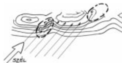
5. ábra. Dűznihatás oldalszélben
